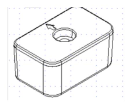
EMITTIMS模具智能计数器是广东新睿仕德智能系统有限公司开发的模具智能化数据采集器,属于无源设备互联智能化数据采集器。产品自带无线定位模块、计数模块和数据传输模块。主要功能是自动为模具提供位置信息、数量信息和成型周期等信息,利用以上信息通过软件系统大量逻辑运算为模具全流程监控和运营提供智能化管理。运营管理平台主要解决大量模具在注塑和冲压生产过程中运营管理难的痛点问题,应用场景:主机企业(美的、华为等)有大量模具外发多家供应商生产[MITT模具生产运营智能管理系统化解决方案,通过模具智能RFID数据采集器[4G]5G智能采集器配合智能化管理系统对模具进行全生命周期管理,解决企业大量模具外协供应商生产难以运营管理的痛点问题。计数架构:每套模具安装智能数据采集器一个(内置定位、计数、通讯模块)自动采集数据,系统通过4G[5G通讯基站定位及传输数据,云端服务器数据运算;云端服务器运行智能化管理系统,通过系统完成数据智能化运算,展示在企业PC端、移动端和电子看板;通过模具智能数据采集器实时采集数据,云端计算,通过PC端、移动端和电子看板呈现数据报表、异常实时提醒等智能化管理。117
